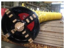
当時使用した掘進機 (機長10m、5関節)
