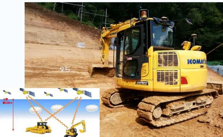
マルチGNSSの採用で、準天頂衛星「みちびき」の測位情報を受信し、ブームまたはバケットを操作した際に、バケット刃先が設計面に達すると作業機が自動で停止します。
