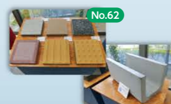
No.62 焼却灰の有効利用「エコセメント」 Recycling Incinerator Ash into Eco-Cement
