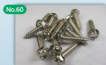
No.60 環境低負荷型 クエン酸ニッケルめっきの開発 Nickel Electroplating Method with Low Environmental Impact
