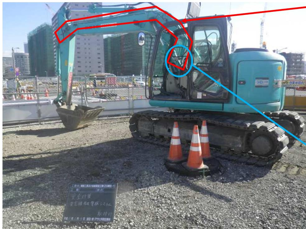
バックホウに架空線接近警報システムを設置。
