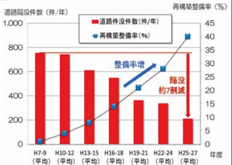
<都心部再構築エリア道路陥没件数の推移>
